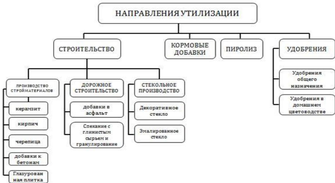
Рисунок 1 – Возможные пути утилизации осадков сточных вод.
