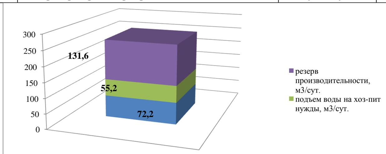
**Заключение:** производительности водозаборных сооружений превышает фактическое водопотребление. Имеется резерв (50,8%).
