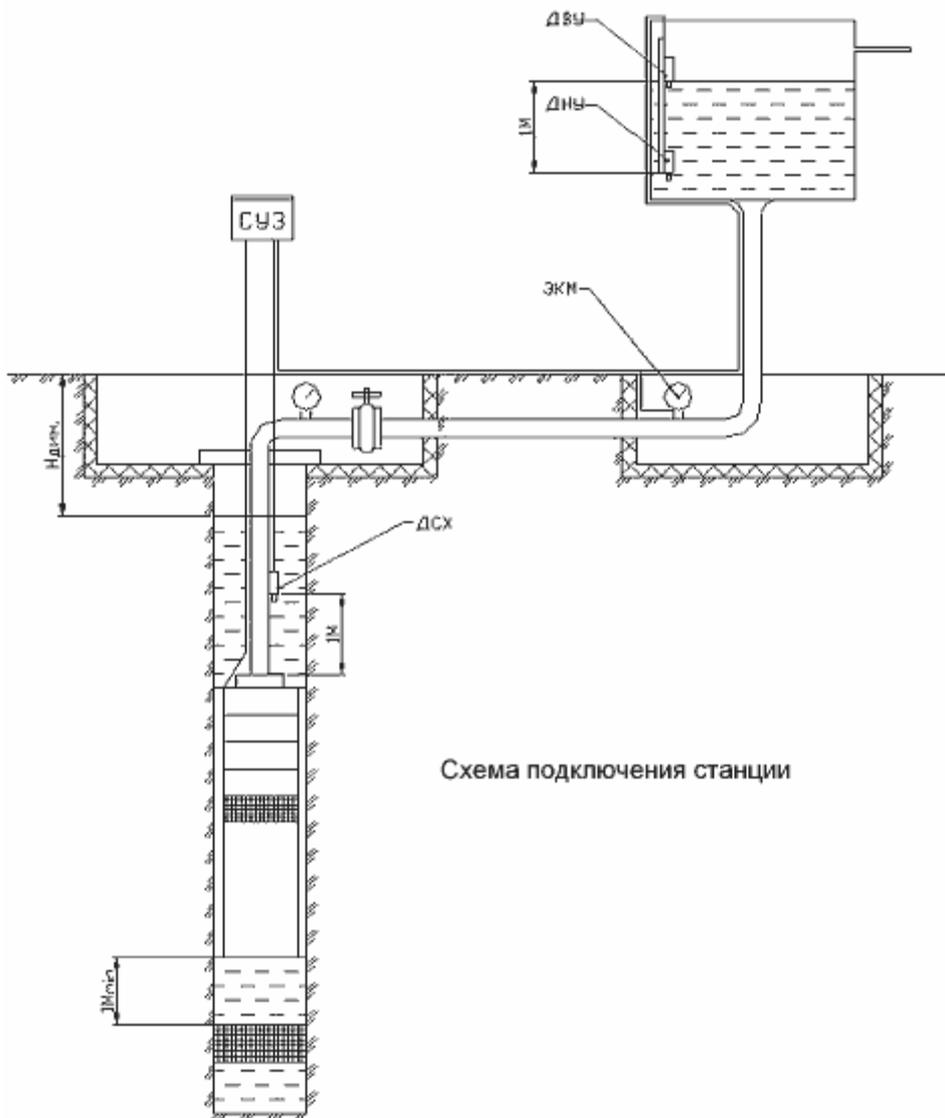
Схема подключения станции
